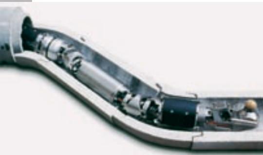
Reparatur: Roboter mit Fräskopf
